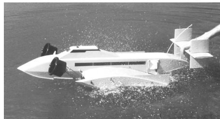
Figure 4 : Testing the tilting PAR fans on MK2
